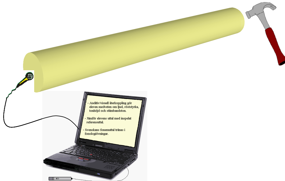
Figur 2. Princip för mätning av egenfrekvens i en stock.
