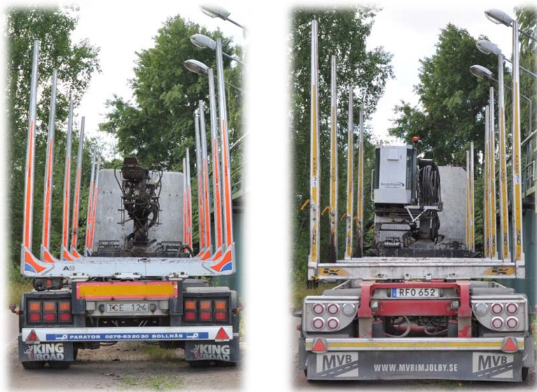
Figur 2. Bild på de ekipage som ingick i stresstestet. ExTe till vänster och Laxo till höger. Observera skillnaderna i lutning på stakarna, där stakarna från ExTe lutar svagt inåt när ekipaget är olastat.
